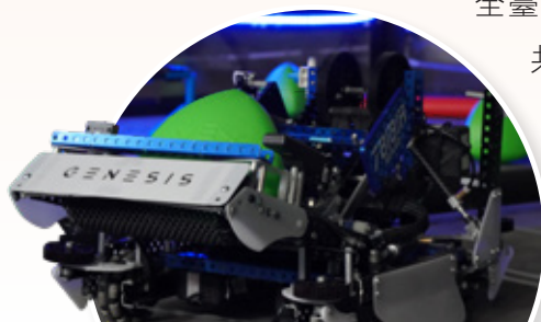
「78181A-Genesis隊」參賽作品「Jackson Storm機器人」，採用鋁製結構、定制塑料零件、電氣布線和氣壓系統，具快速靈敏移動、攀爬及穿越障礙物，使競賽獲得高分
